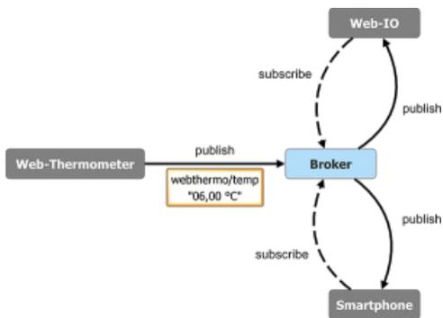
Wie auch beim Cloud-Ansatz, bauen die Kommunikationsteilnehmer (Clients) bei MQTT aktiv eine Verbindung zu einem zentralen Dienst, dem Broker, auf.
